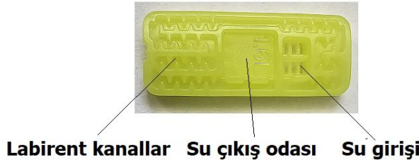
Şekil 1. SERTSAN Damla Sulama Borularında (1.6 L/h anma debili) kullanılan yassı damlatıcının genel görünüşü
