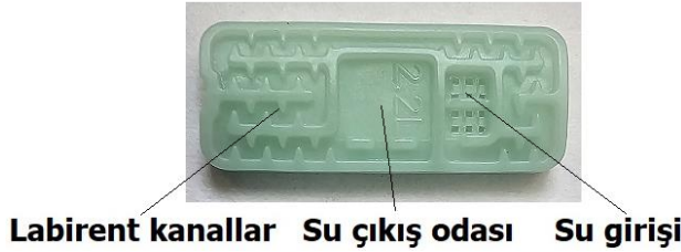
Şekil 1. SERTSAN Damla Sulama Borularında (2.2 L/h anma debili) kullanılan yassı damlatıcının genel görünüşü
